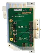
IoT 正面 预留两个 mini-PCIE插槽
