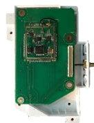
IoT 背面 已集成医惠RFID 非mini-PCIE插卡
